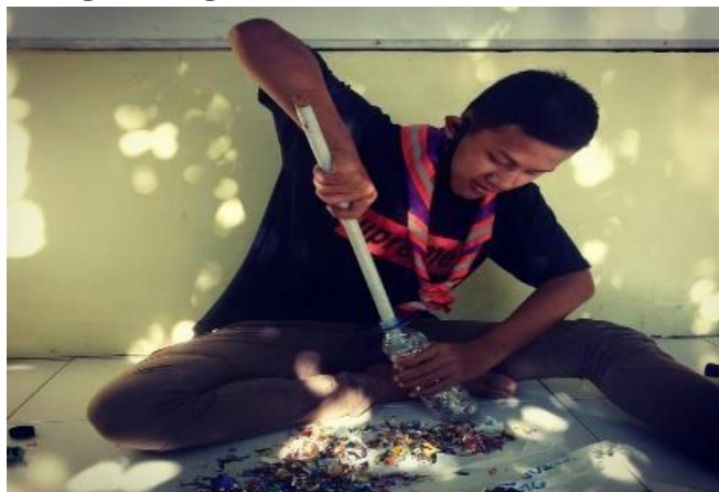
Gambar 3. Pemadatan Potongan Limbah Dalam Botol
