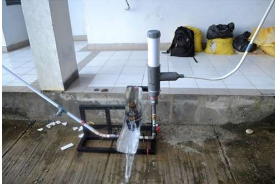
Gambar 7. Pompa Hidram Ketika diberi Masa Beban 0,75 Kg
