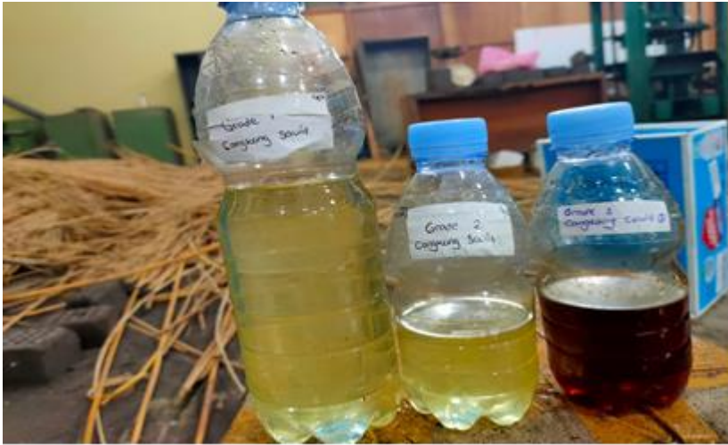
Gambar 7. Penampakan Warna yang Berbeda Berdasarkan Grade Asap Cair dari Cangkang Kelapa Sawit (dari Kanan ke Kiri: Grade 3, Grade 2, dan Grade 1).
