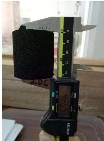
Gambar 5. Pengukuran Dimensi Briket Arang dari Cangkang Pelepah Kelapa Sawit
