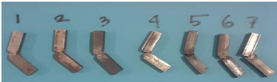
Gambar 6. Hasil Pengujian Charpy Suhu 250 °C
