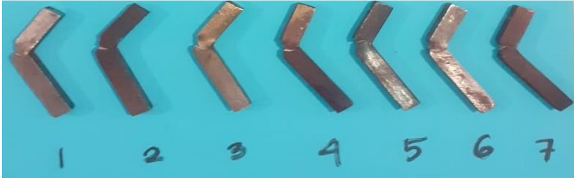
Gambar 9. Hasil Pengujian Izod Suhu 150 °C
