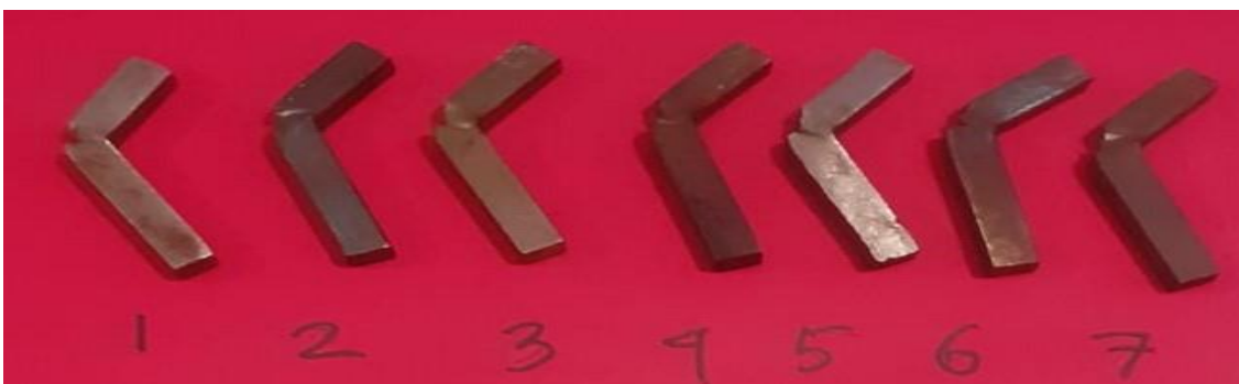
Gambar 10. Hasil Pengujian Izod Suhu 250 °C
