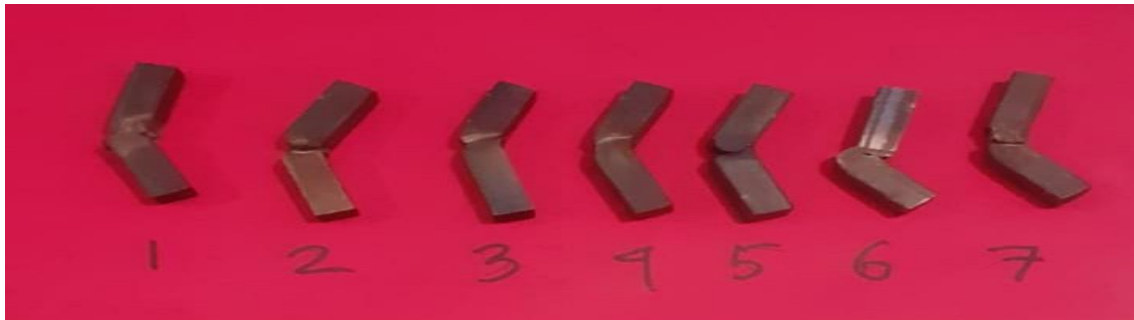
Gambar 5. Hasil Pengujian Charpy Suhu 150 °C
