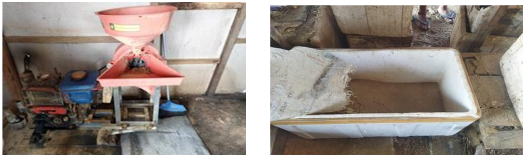
Gambar 4. Alat penggilingan yang digunakan dan hasil penggilingan (tepung ikan)
