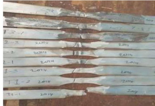
Gambar 4. Spesimen Setelah Uji Tarik
