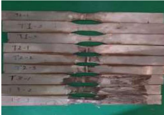
Gambar 3. Spesimen Setelah Uji Tarik
