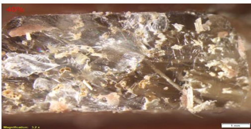
Gambar 9. Hasil Patahan Setelah Pengujian Tarik
