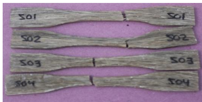
Gambar 5. Spesimen Hasil Uji Tarik
