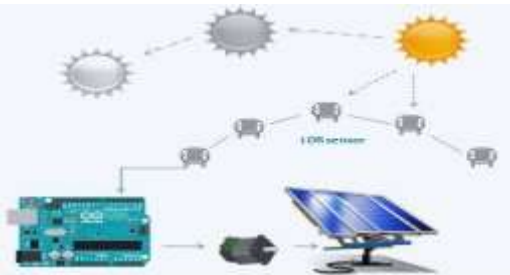
Gambar 6. Prinsip Kerja Tracking Solar Cell (Sumber : Desain Pribadi)
